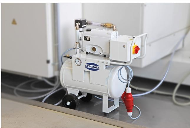
Vakuum-Aggregat VAGG zur Vakuum-Erzeugung in der Nassbearbeitung
